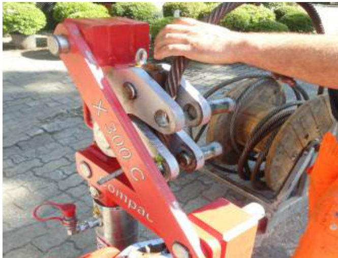
Заправка в головку установки стального троса.
